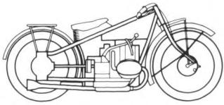
Neuer Rahmen mit geraden Frontrohren und gebogener Sattelstütze, leistungsstärkerer Motor mit querverrippten sv-Zylindern und abnehmbaren Alu-Zylinderdeckeln, neues Kegelradgehäuse mit Ölschmierung und Seitenwagenanschluss, Kardanbremse.
