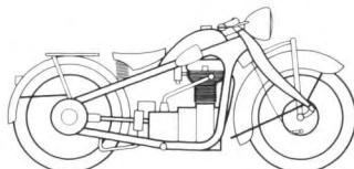
Pressstahlprofile für Rahmen und Gabelholme ersetzen die bisherigen gemufften und verlötzten Rohre. Die stetige Weiterentwicklung der Motoren bringt für die fünfte Serie 1934 eine kettengetriebene (vorher Zahnräder) Nockenwelle sowie zwei Vergaser.
